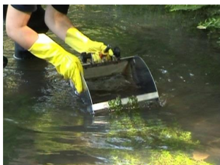
Photo 4 : Prélèvement au filet Surber
