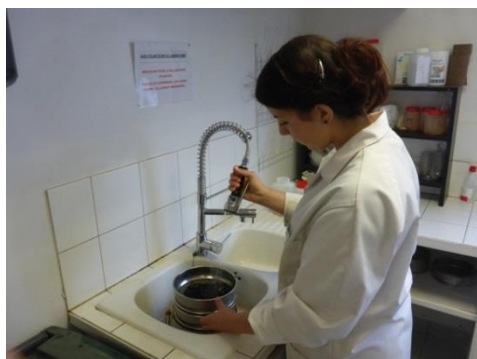
Photo 6 : Nettoyage et tamisage des échantillons
